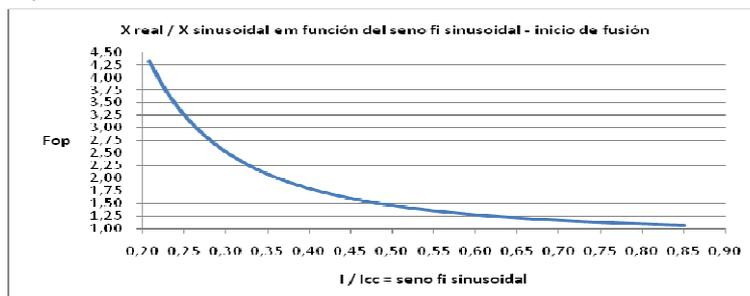
**Figura 2.** “Reactancia real/reactancia sinusoidal” en función del seno  $\phi$  sinusoidal
